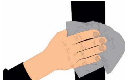
۱- تمیز و خشک کردن پروفیل‌های قائم.
