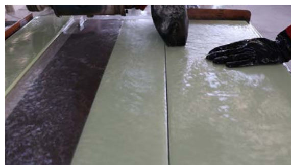
برش سرامیک پرسلانی با دستگاه آب بُر
